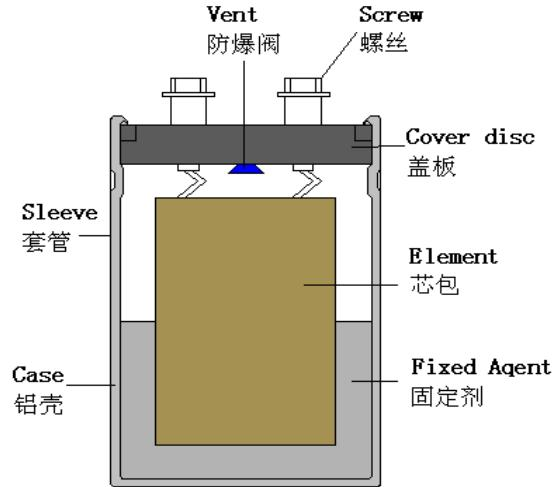
7-2 工艺芯包分解图 (Element drawing)
